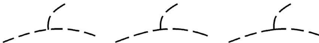
Рис. 16а: Обычная точка; Рис. 16б: Точка для соединения пунктиров; Рис. 16с: Угловая точка
