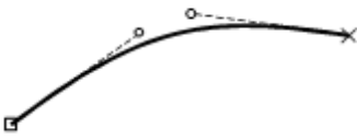
Fig. 13: Une courbe de Bézier, avec l'affichage de son point initial, des sommets, des tangentes et de son point final.
