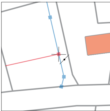
Fig. 1: Snapping: Durch den Wechsel des Cursorzeichens wird angezeigt, ob die neue Linie präzise auf der Linie, an einem Stützpunkt oder an einem Ende einer Linie platziert wird.
